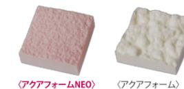
ピンク色の吹付け硬質ウレタンフォーム「アクアフォームNEO」。現場発泡の吹付け工事を行い、高性能な発泡剤を含んだウレタンフォームを構造材に密着させることで同時に気密工事を行います。
